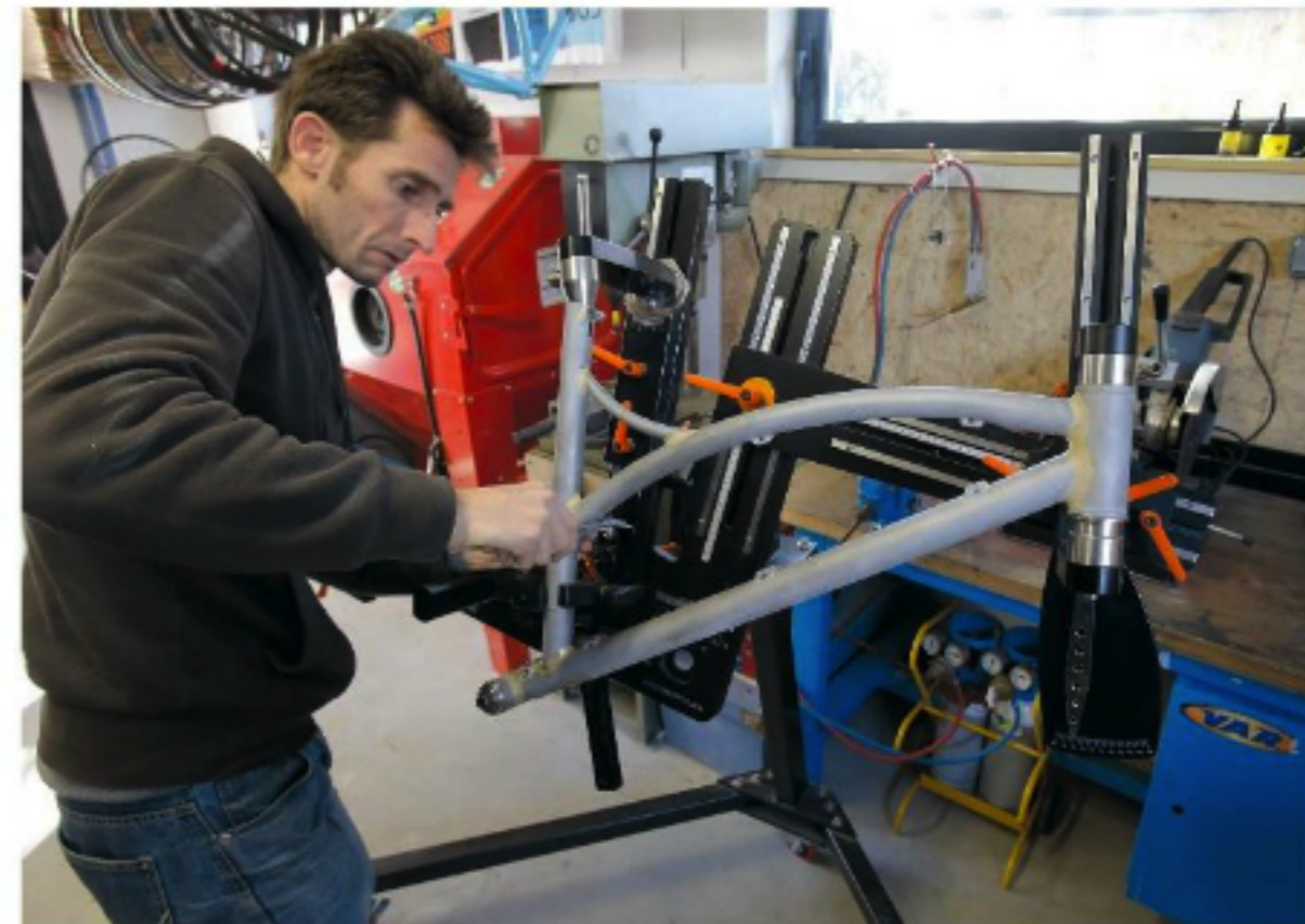
Ce marbre sur lequel Brice réalise ses prototypes n'est pas un simple support. Il permet d'alimenter l'intérieur des tubes en gaz Argon, et ainsi, de souder du titane...
