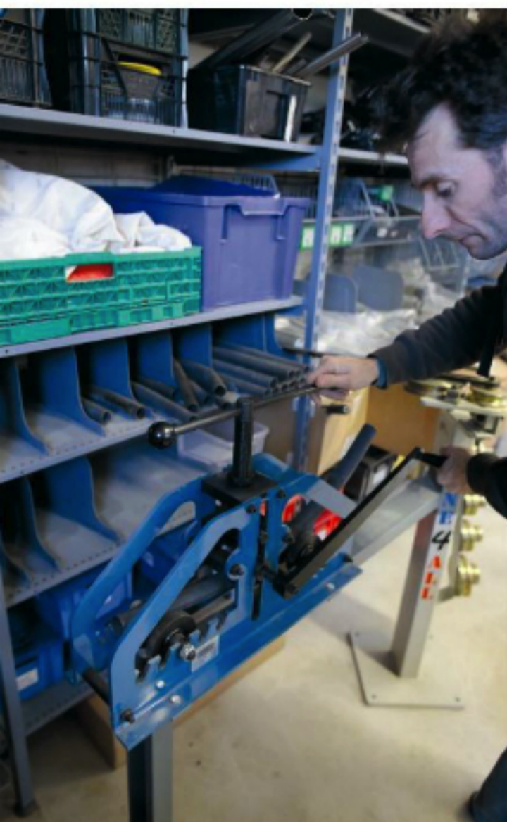
Une cintruse permet de travailler les tubes pour la réalisation de prototypes ou pièces spéciales.
