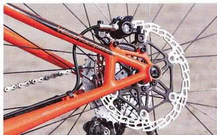
Vue sur l'insertion du support d'étrier sur un hauban fin qui filtre parfaitement les vibrations.
