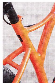
C'est dans cette zone que se fait la rigidité du triangle avant. On remarque aussi et surtout le cintrage des tubes et des soudures, à l'abri de tout reproche !
