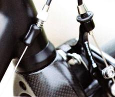
e câble de frein arrière passe en interne tandis que eux du dérailleur restent externes. On admire les oudures polies impeccables et les différents arrêts e gaines. Serrage de selle et direction intégrés, cette ernière en diamètre constant 1"1/8. La finition est de aut niveau.
